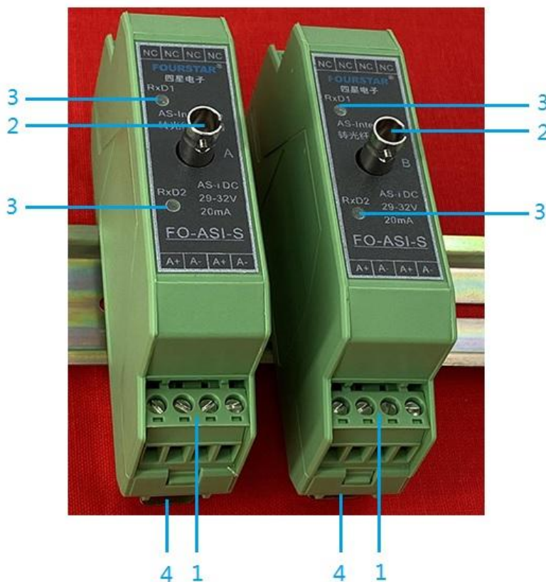
图 3-1 ASI-RPT03 外部结构图
